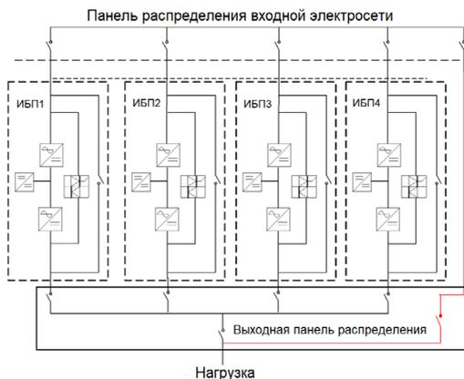
Рисунок 5.3. Схема параллельного подключения
